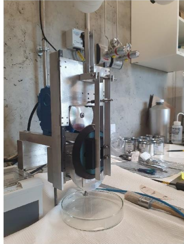
Figur 2. Instrument til kontrolleret slid af plader påført maling
